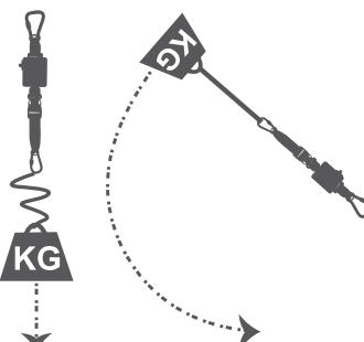
Se une el lanyard a un punto de anclaje y al otro extremo se le aplica la carga. La carga se eleva y se suelta verticalmente, 5 veces.
