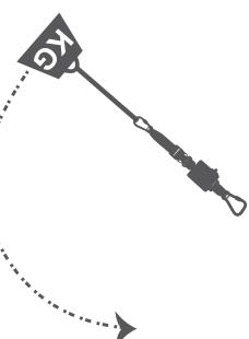
Se une el lanyard a un punto de anclaje y al otro extremo se le aplica la carga. Se eleva la carga por encima del punto de anclaje y se suelta, 5 veces.
